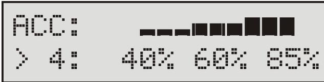
Links unten wird die Nummer der Kurve angezeigt, je höher der angezeigte Prozentwert, desto höher die Beschleunigung/Verzögerung. Der linke Prozentwert für den unteren - der rechte für den oberen Drehzahlbereich.
